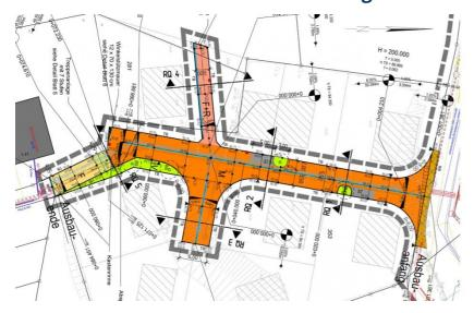
Erschließung des ca. 0,45 ha großen Gebietes "In der Liethe" in Dortmund-Grevel. Leistungsphasen 1 bis 8 für die Herstellung der Erschließungsstraßen als Mischverkehrsflächen in Pflasterbauweise sowie einer bis zu ca. 1,25 m hohen Stützwand aus Stahlbetonrohr zur Abfangung des Höhenunterschiedes zum östlich angrenzenden Gebäude.
