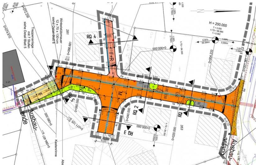
Erschließung des ca. 0,45 ha großen Gebietes „In der Liethe“ in Dortmund-Grevel. Leistungsphasen 1 bis 8 für die Herstellung der Erschließungsstraßen als Mischverkehrsflächen in Pflasterbauweise sowie einer bis zu ca. 1,25 m hohen Stützwand aus Stahlbetonrohr zur Abfangung des Höhenunterschiedes zum östlich angrenzenden Gebäude.
