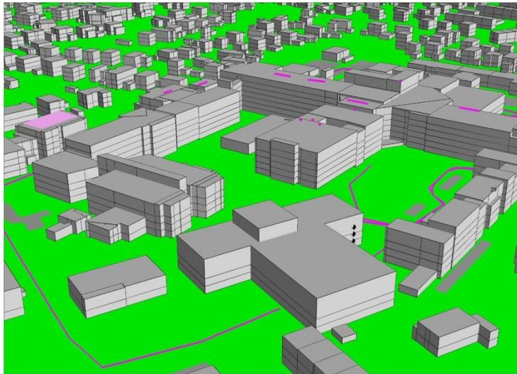
Für die geplanten Patientenzimmer war der Beurteilungspegel durch die einwirkenden Schallquellen (einschließlich der Schallquellen des WKK) zur Tag- und Nachtzeit gemäß der TA Lärm zu ermitteln.
