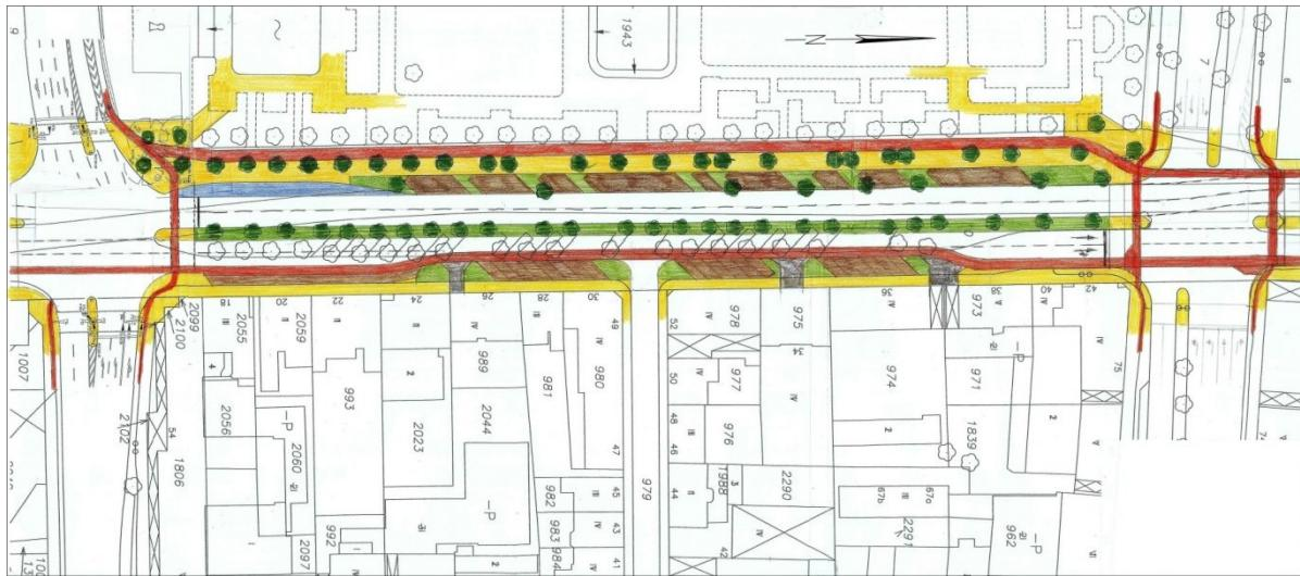
In der Max-Brauer-Allee in Hamburg Altona sind die vorhandenen Radverkehrsanlagen nicht mehr regelkonform und unsicher. Im Zusammenhang mit der Neugestaltung der Fußgängerunterführung Max-Brauer-Allee sollte untersucht werden, welche Möglichkeiten es für eine regelkonforme Modernisierung der Radverkehrsanlagen gibt.
