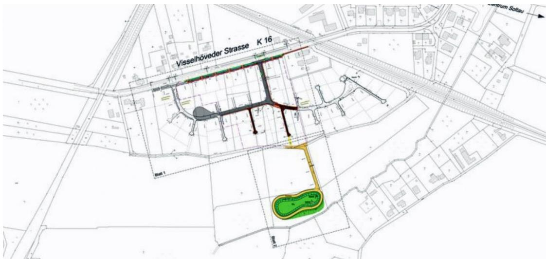
Die Stadt Soltau hat am südwestlichen Rand der Stadt den B-Plan 103 als Wohngebiet neu entwickelt. Das Gebiet sollte 2013 zum Teil erschlossen werden. Hierzu musste die Entwässerung schon für den Endzustand auch der späteren Erweiterung dimensioniert und geplant werden. Das Regenrückhaltebecken musste unter Absenkung des Grundwasserspiegels hergestellt werden. Des Weiteren wurde ein Schmutzwasserpumpwerk geplant.
