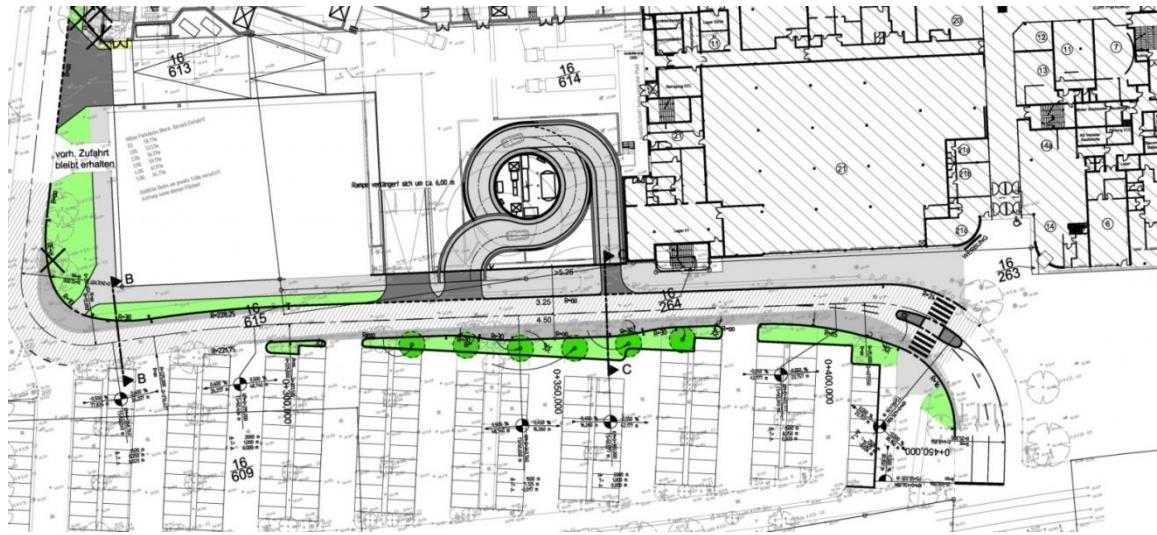
Im Zuge der Revitalisierung der CCL wurde die Parkplatzkapazität mehr als verdoppelt. Die vorhandene Erschließung des Parkdecks wurde komplett erneuert und aktuellen Anforderungen angepasst. Die veraltete Spindel wurde komplett überplant und neu gebaut. Außerdem wurden die äußere Erschließung und die Signalschaltungen der angrenzenden Knotenpunkte angepasst.
