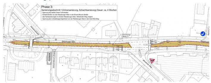
In der Ratzeburger Allee in Lübeck wurde festgestellt, dass große Teile des Mischwasserkanals (Eiprofil DN 1138/1700) defekt bzw. abgängig sind. Aufgrund der Schwere der Schäden bestand kurzfristiger Handlungsbedarf.
